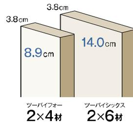
外壁の枠組に骨太な2×6材を仕様。耐震性が向上するだけでなく断熱性や遮音性もアップします。
